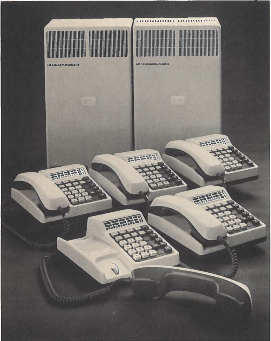
fig. 1. TR43 toestelinstallatie van kleine samenstelling. In de linkerwandkast bevindt zich de hoofdverdeler, in de rechter de basisapparatuur.
